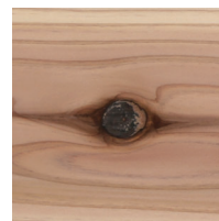
パテ・埋め木処理
