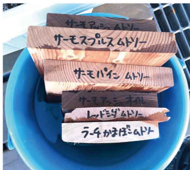
▲ 吸水試験 (寸法変化・腐食を確認)
