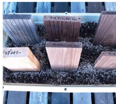
▲ 腐葉土への埋没試験 (腐食・白蟻食害を確認)
