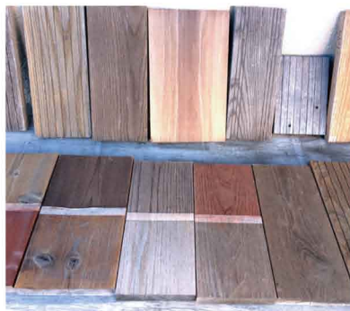
▲ 暴露試験 (色の変化・表面変化の確認)
